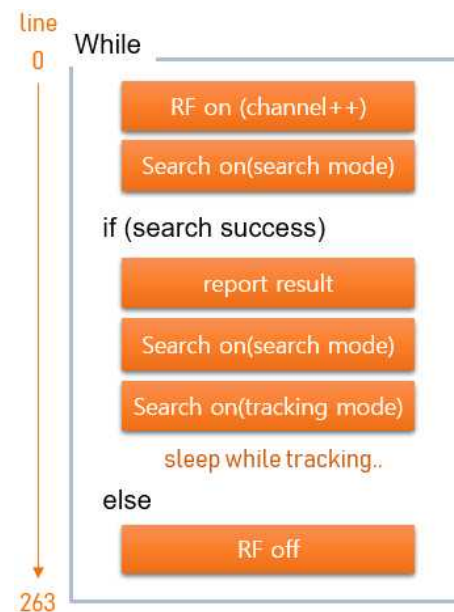
<그림1> OAI synchronization process
